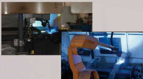
Soldadura ejes y direccionales
